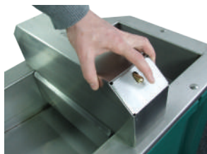
Werkzeugloses Öffnen der Abdeckung
